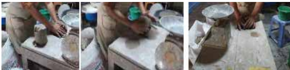
Gambar 23. Proses Penguletan Tanah Liat Foto: Rai, 2021
